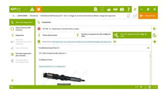
Guías de reparación **SMART** por código de fallo en el sistema de control del motor **ECU EUI (Level 15 - Tier 3 / Stage III A)**.
